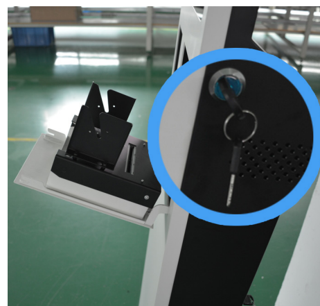
Llave y cerradura para acceso al hardware interno
